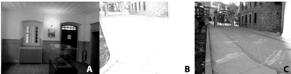
Figure 5 : Images représentant la séquence de sortie du bâtiment et l'effet *white-out* 4 a) intérieur au  $t = 52$  secondes et avec une luminance moyenne de  $1000 \text{ cd/m}^2$  4 b) phénomène du *white-out* au  $t = 55$  et avec une luminance moyenne de  $7000 \text{ cd/m}^2$  4 c) extérieur au  $t = 57$  et avec une luminance moyenne  $5300 \text{ cd/m}^2$ .
